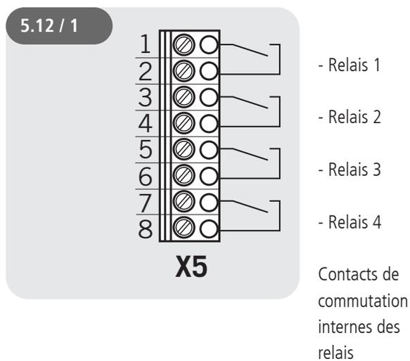
Il s'agit de quatre sorties de relais sans potentiel avec une capacité de charge maximale de 4A pour 230V/1~.
