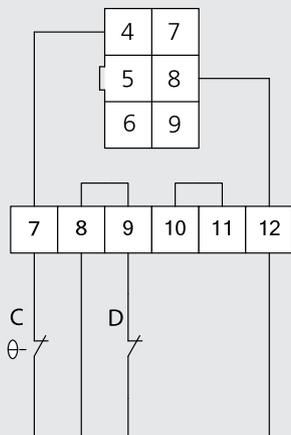
C : Thermocouple dans mécanisme d'entraînement
